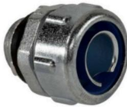
El **Conector Metálico Recto** permite unir tuberías metálicas rígidas o flexibles, asegurando continuidad mecánica y eléctrica. Su cuerpo fundido en zinc y junta de neopreno proporcionan sellado contra polvo, líquidos y grasa, mientras los tornillos de acero aseguran una fijación firme. Fabricado conforme a la norma **IEC 61386**, garantiza resistencia a la tracción,
