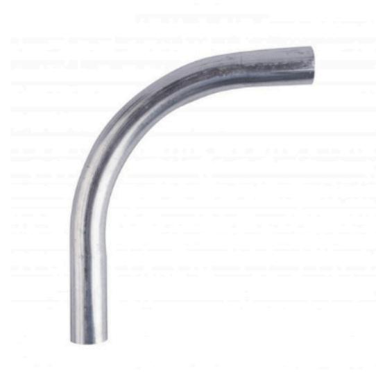
La **curva metálica EMT** permite realizar giros de 90° en la canalización eléctrica, permitiendo redirigir el trayecto del conduit sin necesidad de curvar la tubería rígida. Fabricada en **acero galvanizado**, ofrece buena resistencia mecánica y protección contra la corrosión. Es compatible con estándares IEC 61386-21 para accesorios de canalización metálica.
