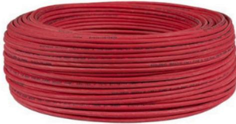
El **Cable H07Z1-K** es la elección profesional para instalaciones que demandan el más alto nivel de seguridad. Este conductor flexible, de color **ROJO**, utiliza un aislamiento de tipo **EVA (Etileno Vinil Acetato)**, lo que lo clasifica como un cable **libre de halógenos (LSZH)**. Con una tensión nominal de **450/750 V**, soporta aplicaciones estándar de baja tensión y es ideal para ambientes
